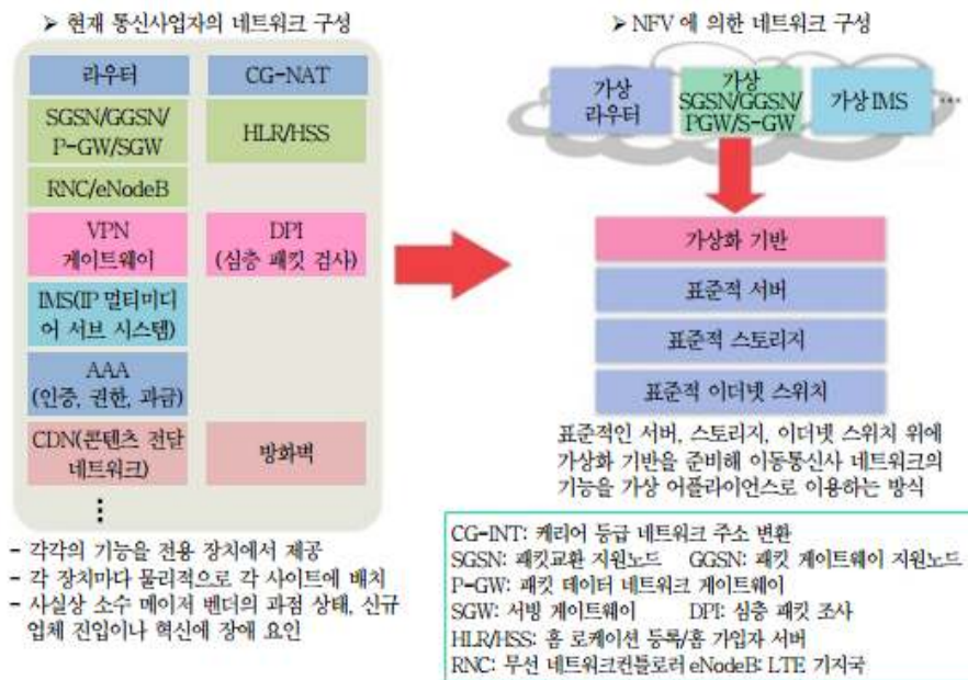
[그림 1] 기존 통신사업자의 네트워크 구성과 NFV에 의한 네트워크 구성의 비교
