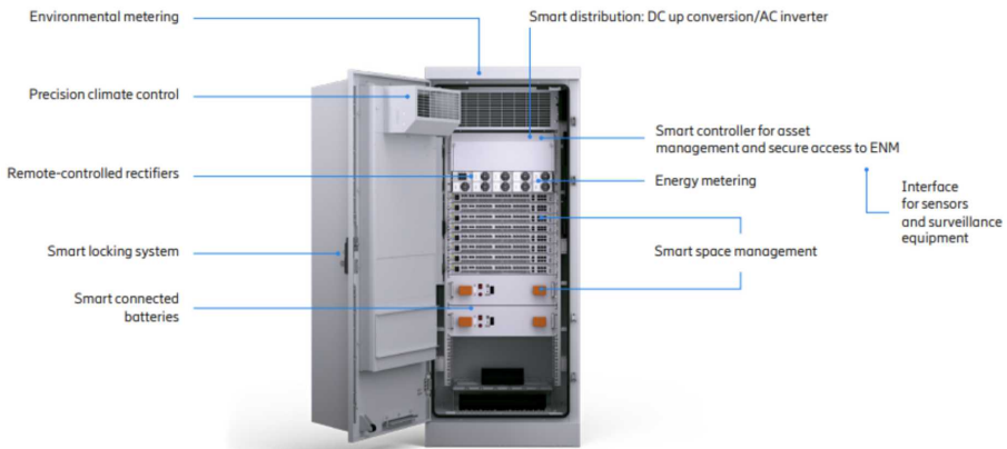
[그림 3-20] Ericsson에서 개발한 Smart Connected Site 기지국
