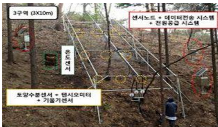
[그림 5-2] 산사태 무인원격 감시시스템 구조
